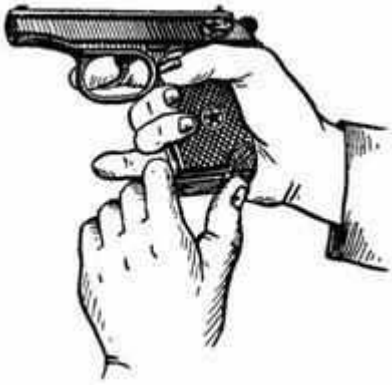
Рис. Извлечение магазина из основания рукоятки
