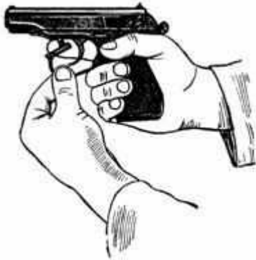
Рис. Оттягивание спусковой скобы
