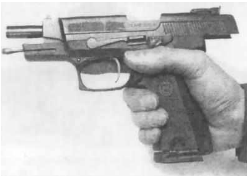
Рис. Отведение затвора в крайнее заднее положение
