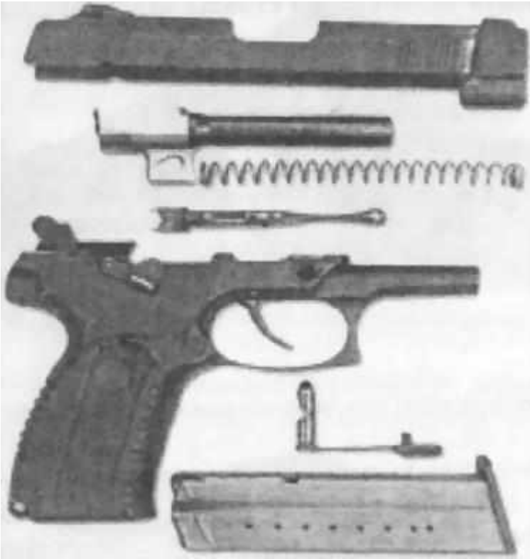
Рис. Пистолета Ярыгина после неполной разборки
