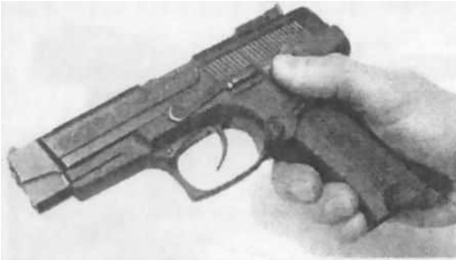
Рис. Постановка пистолета на предохранитель
