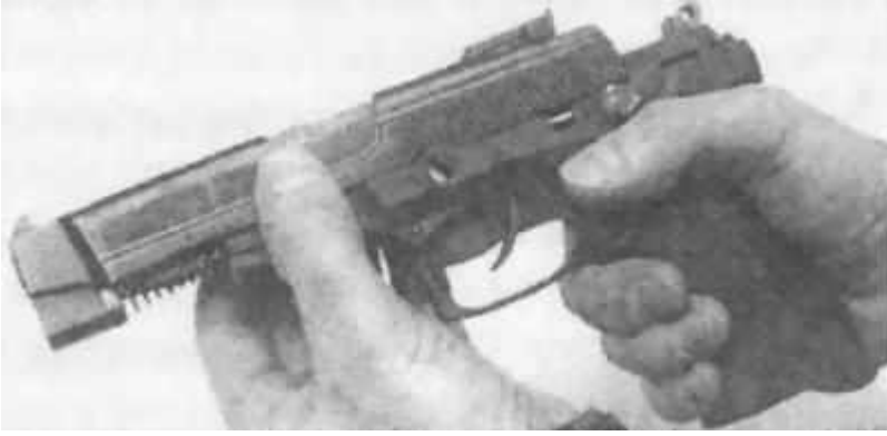
Рис. Отделение затвора со стволом и возвратным механизмом от рамки
